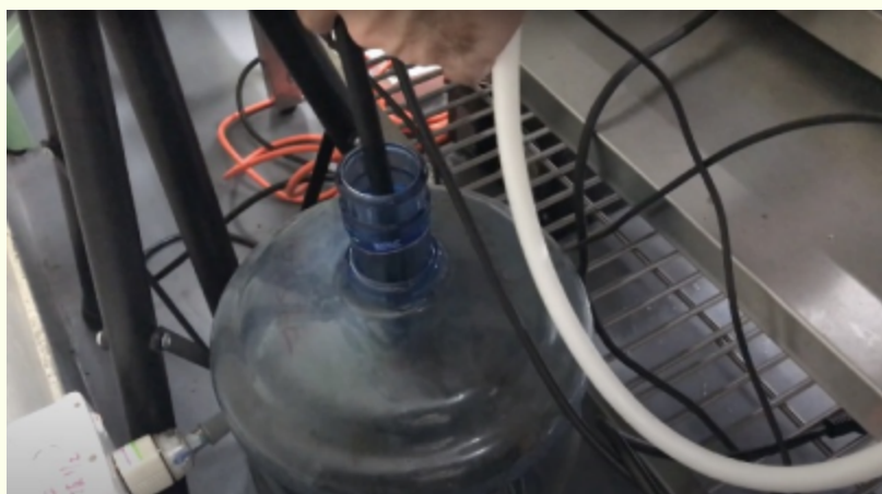
废水从滴水盘通过黑色管排出到废水箱中进行处理。
