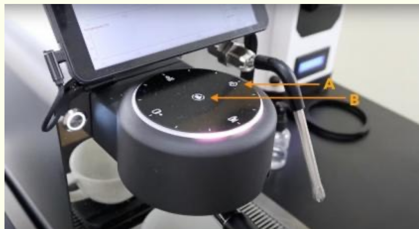
按蒸汽按钮（上图A位置）开始，当牛奶的温度达到约65° C 时按停止按钮（上图B位置）。
