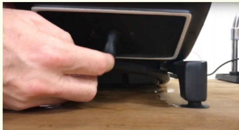
较短的管子从插入滴水盘底部废水口
