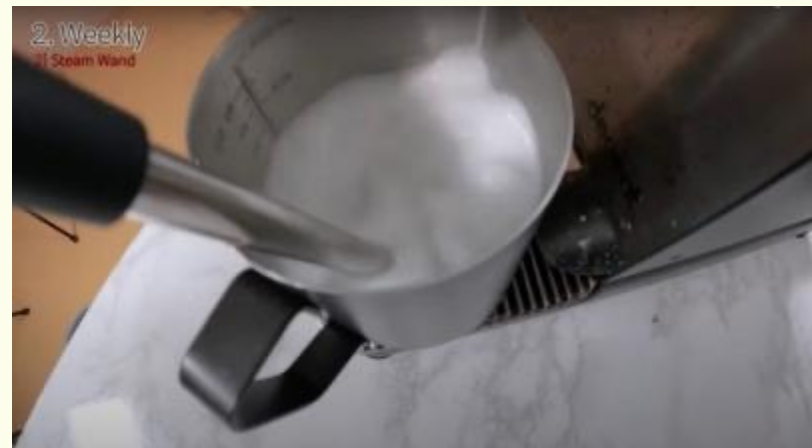
在Rinza和水的溶液中使蒸汽棒打蒸汽
