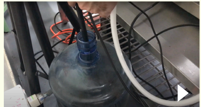
L'eau usée s'écoule du bac égouttoir par un tube noir dans une bouteille pour y être jetée.
