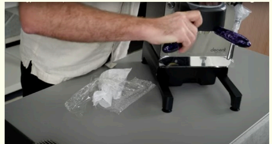
Insertion du porte-filtre près de la poignée de la tête de groupe.
