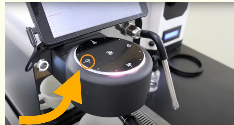
El botón de Purga del cabezal del grupo.
