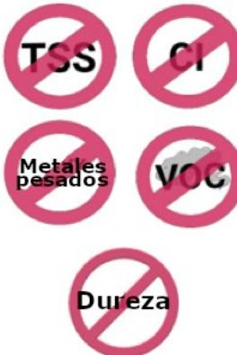
La ósmosis inversa (OI) es la filtración mediante presión a través de una membrana filtrante semipermeable. Está disponible tanto para uso comercial como doméstico, y es la forma más común de tratar el agua en aplicaciones comerciales de café. Este proceso elimina la mayor parte del contenido mineral del agua para reducir su dureza.
